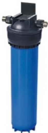
Исходная вода поступает на фильтр грубой очистки. Фильтр предназначен для удаления крупных частиц – окалины, сварочного грата и песка, который может выноситься из подводящих трубопроводов. Установка состоит из корпуса фильтра, соединительных узлов на  $\frac{3}{4}$ , кронштейна, для крепления фильтра, и ключа.
